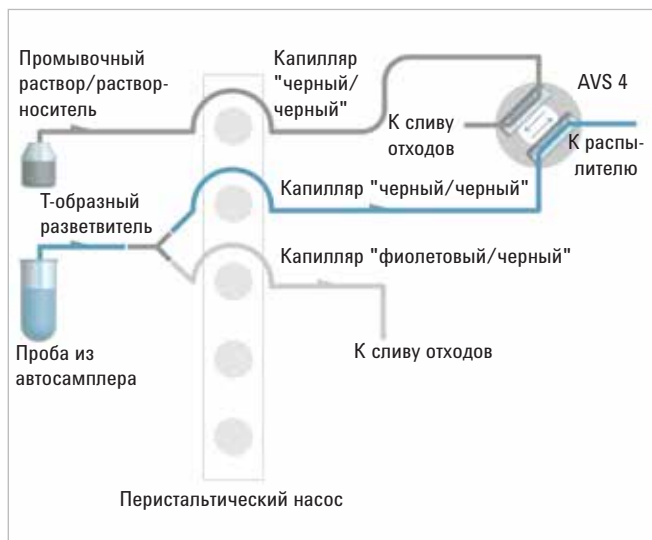
Рис. 2. Применение подхода быстрого потока для увеличения скорости потока пробы.
