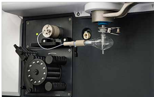
Рис. 1. Прибор МП-АЭС Agilent 4210 с усовершенствованной системой быстрого переключения потоков Agilent AVS 4 с четырехпортовым клапаном
